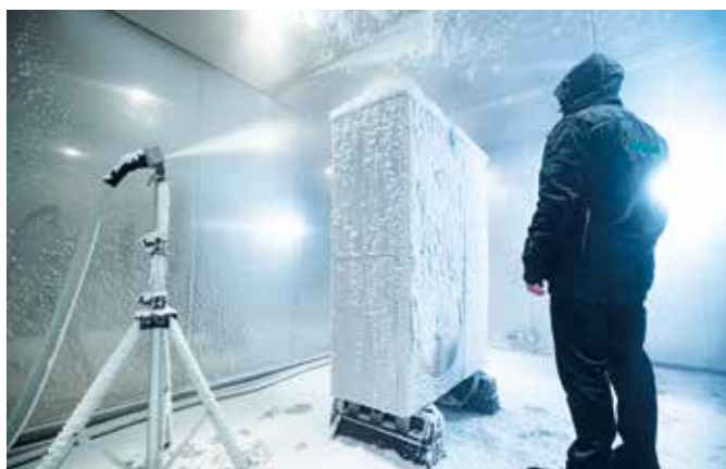
Testhold betjener enhederne under ekstreme klimatiske forhold i klimakammeret
